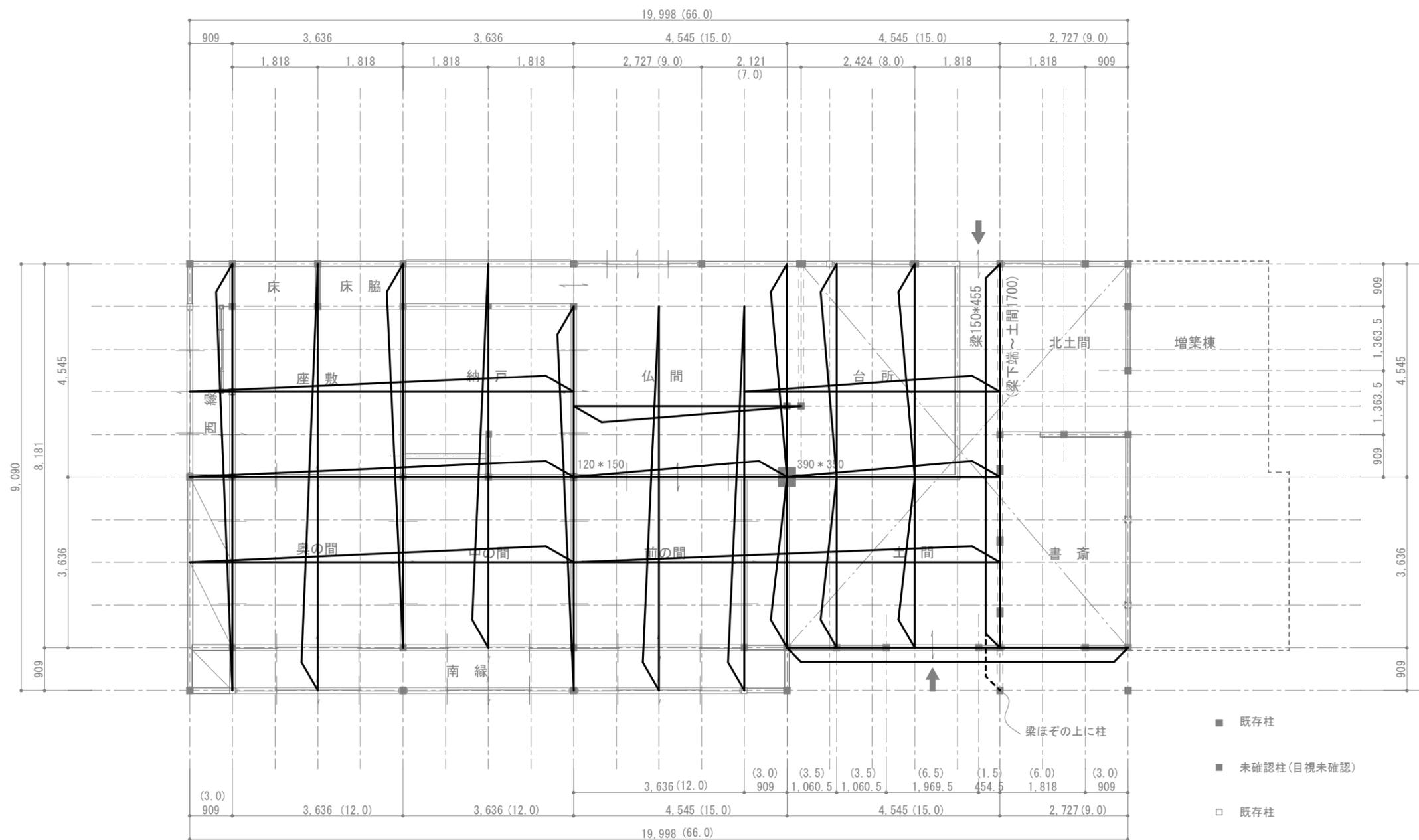
既存 1階平面図 S=1:100 寸法()内数字:尺
